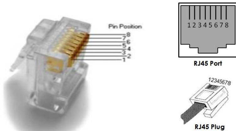
CAN: 通信终端:(RJ45 端口)遵循 CAN 协议,用于电池系统与逆变器之间的通信
