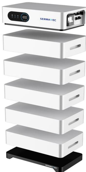
1. 按正确方式堆叠好电池然后将微断开关转到 ON 位置，系统开机，电池堆叠异常时会导致开机异常；正常启动后电池内部的地址自动分配。最上面的主控盒会根据下面的电池盒内上报的内容做判断，判断正常会开机成功，反之异常则无法开机。
